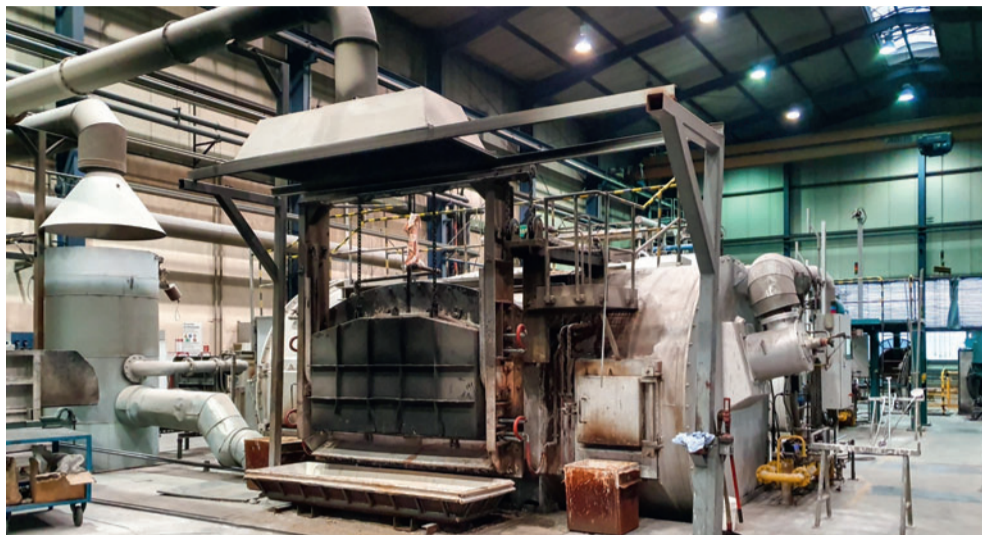
Gießerei in Hettstedt – dort werden aus den anfallenden Schrotten Strangpressbolzen gegossen
